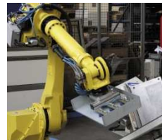
Vollautomatisches Einpressen von Muttern und Bolzen
