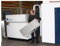
Faserlaser-Netzwerk mit Schneidgeschwindigkeit von über 50 m/min
