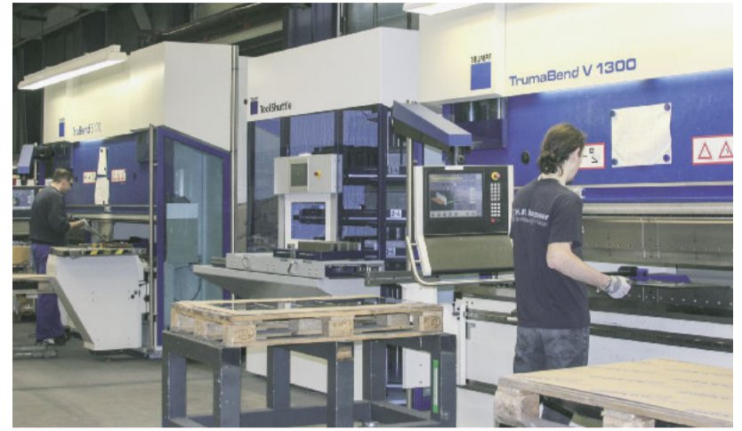
Zwischen zwei Biegemaschinen positioniert, versorgt das Toolshuttle beide Anlagen mit passenden Werkzeugen
