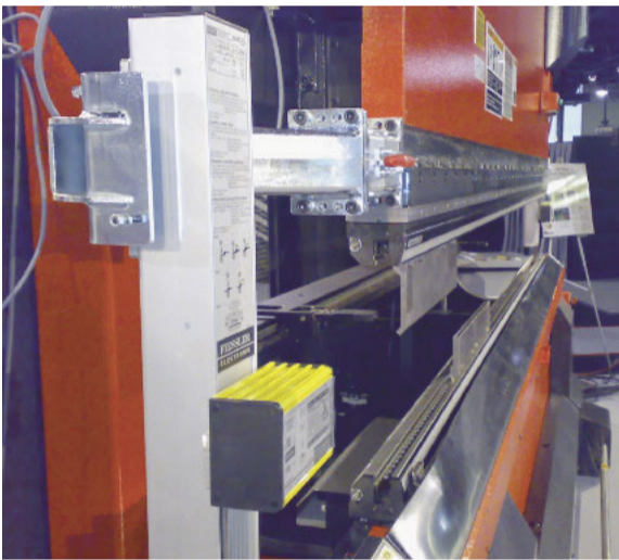
Die Abkantpressen-Sicherheitsysteme Akas_M entsprechen den Anforderungen der EN12622
