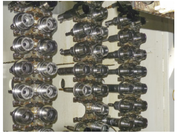
Sowohl die MCH 300 wie MCH 350-C sind mit jeweils 400 Werkzeugen bestückt, die Werkzeugüberwachung ist im Leitrechner des Loadmaster integriert (oben)
