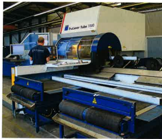
Im Rohrlaser „TruLaser Tube 7000“ erlaubt der frei dreh- und schwenkbare Laserkopf das Schneiden präziser Anfasungen und aufwändiger Aussparungen.
