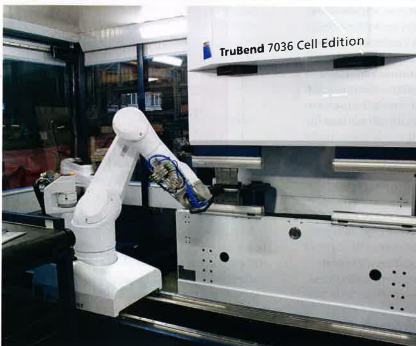
Vollautomatische Biegezeile „TruBend“ mit Robotern zum Wechseln der Biege- werkzeuge und zum Handling der Werkstücke bis hin zur sortierten Ablage.
