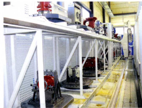
Die automatisierte Einzelteilfertigung mit 20 Paletten-Plätzen wurde innerhalb kürzester Zeit aufgebaut
