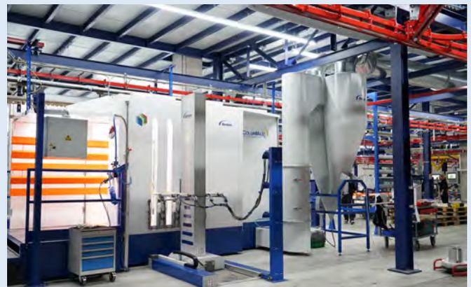
☞ Kabine, Pulverpistolen und Pulverzentrum bilden ein Farbwechsel-System, für das täglich etwa acht weitgehend automatisierte, minutenschnelle und verschleppungsfreie Farbwechsel geplant sind.
