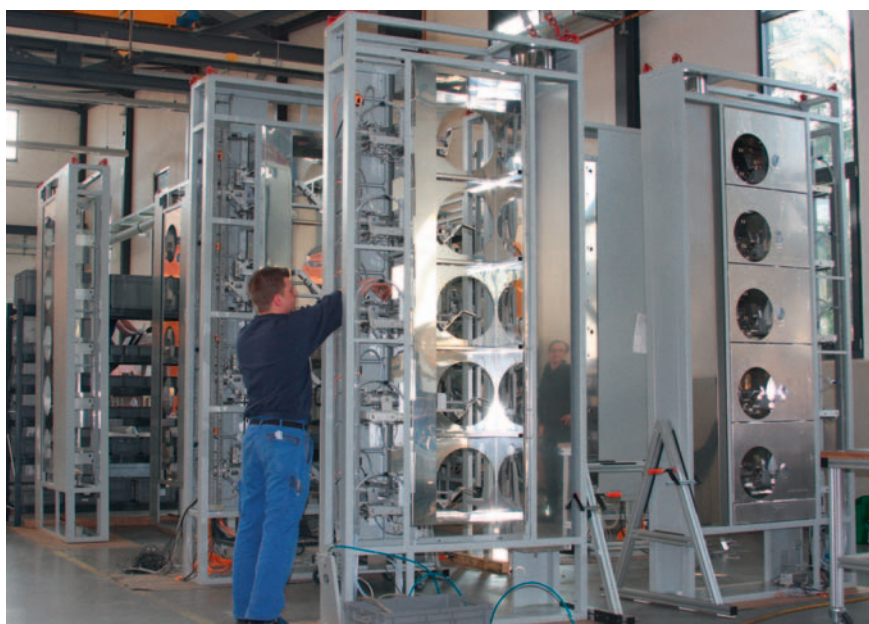
Die Bauteile für den Herstellungsprozess einer Solarzelle werden bei Kaysser nicht nur erstellt und oberflächenbehandelt, sondern auch komplett montiert
