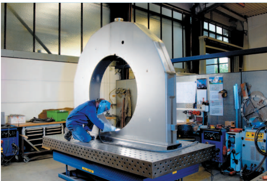
Im handgeführten Schweißprozess entstehen diese Edelstahlschweißbaugruppen für die regenerative Stromgewinnung. Kaysser stellt die gesamte Prozesskette Edelstahl mit allen Verarbeitungsmöglichkeiten zur Verfügung
