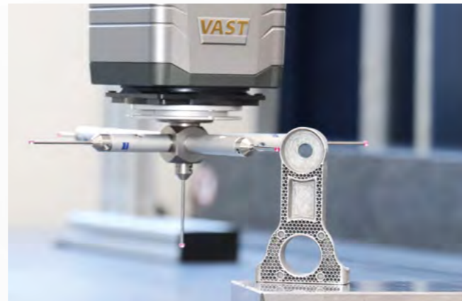
Hochgenaue Vermessung von additiv gefertigten Bauteilen
