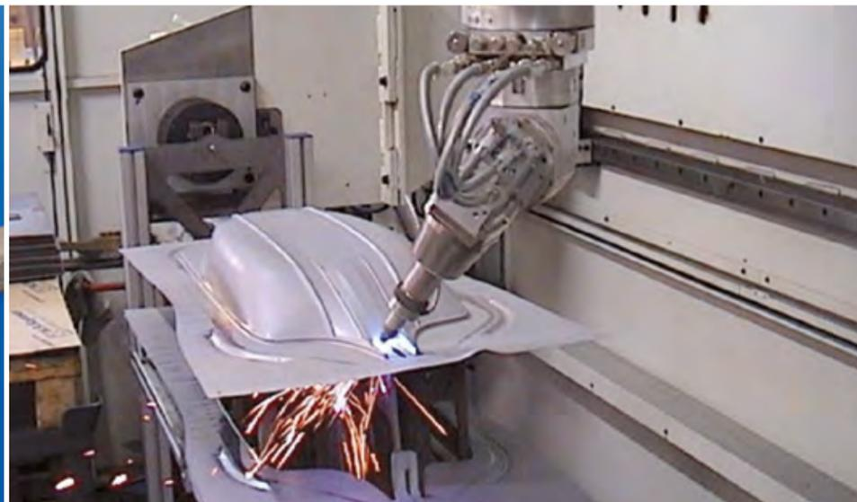
3D-Laserschneiden eines Modellschiffs-Rumpfes
