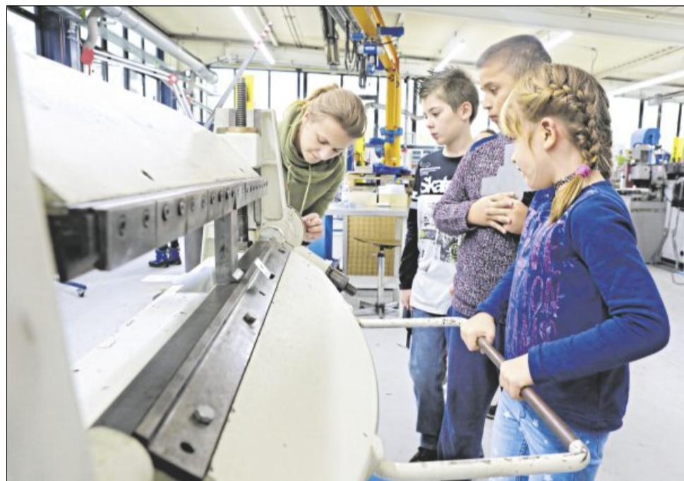
Ann-Kathrin Winter, angehende Lehrerin und derzeit Praktikantin, passt auf, dass der Winkel 90 Grad beim Blechbiegen genau eingehalten wird.
