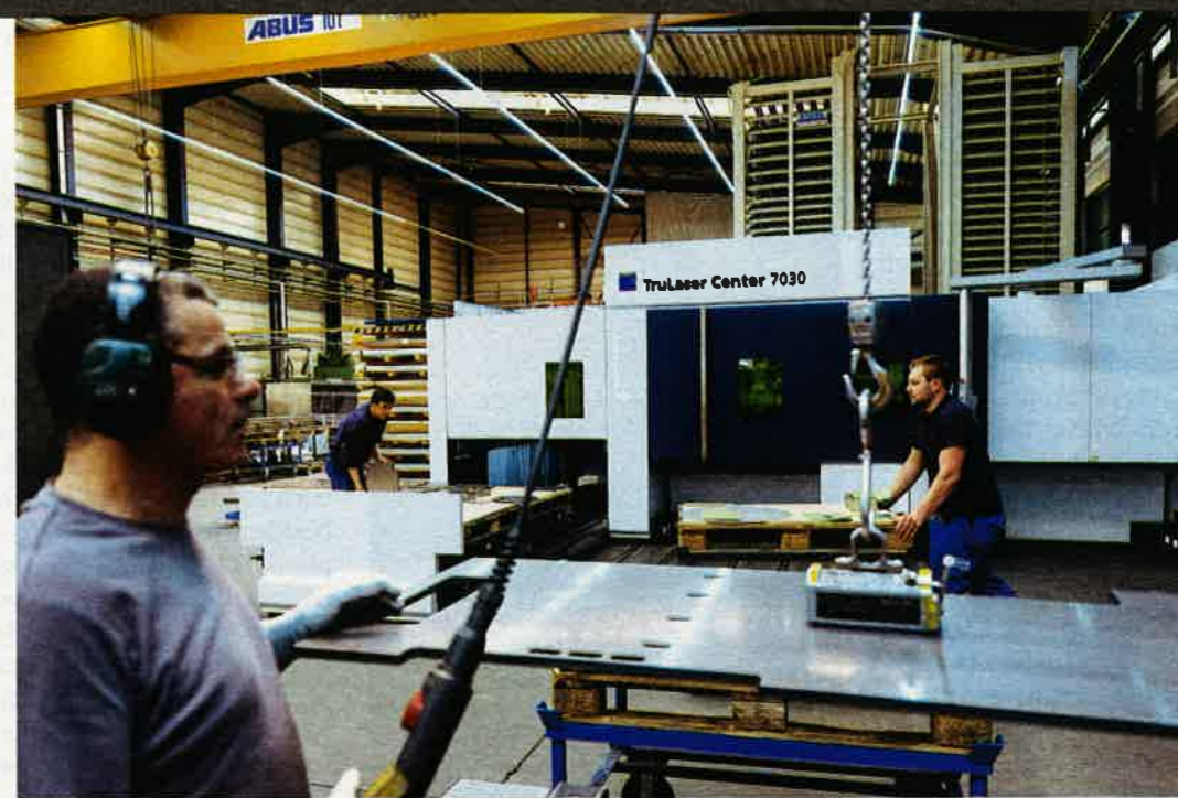
Übermaschine: Bei der Firma H. P. Kaysser läuft die L26 im Alltag. Im blauen Kasten brennt der Laser, links werden die automatisch sortierten Teile entnommen. Theoretisch ersetzt sie drei Viertel der Jobs
