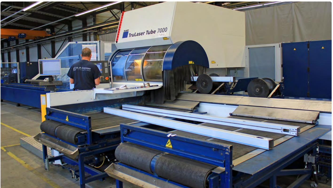
Verarbeitet Material bis 8 mm Wanddicke: Rohrlaser TruLaser Tube 7000
