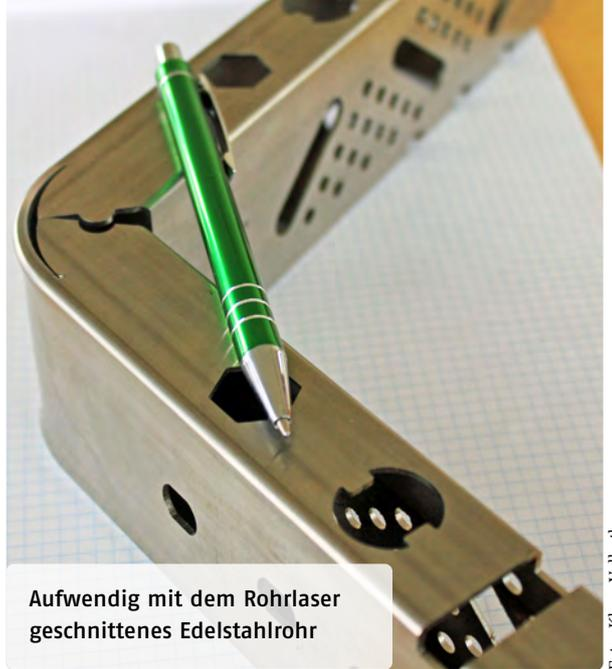
Aufwendig mit dem Rohrlaser geschnittenes Edelstahlrohr
