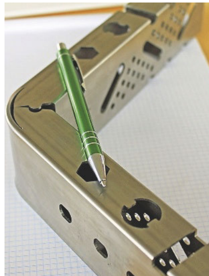
Aufwendig mit dem Rohrlaser geschnittenes Edelstahlrohr. Nach Zusammendrücken in einer Vorrichtung und Verschweißen mittels Lasernaht entsteht ein rechtwinkliges Bauteil mit sanft gerundeter Kante.
