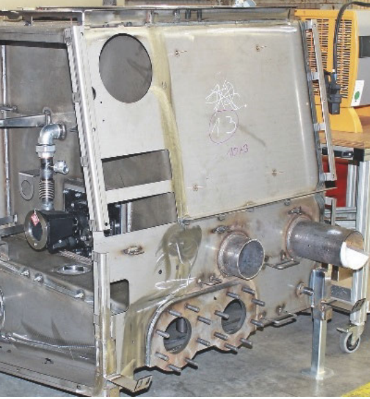
Robbau eines bei Kaysser weitgehend funktionsfertig mit Pumpen, Heizsystem und Zusatzteilen erstellten LKW-Aufbaus für den Einsatz bei Teerarbeiten im Straßenbau.
