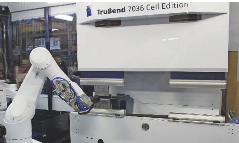
Vollautomatische TruBend-Biegezeile. Der Roboter im Vordergrund wechselt neue Biegewerkzeuge aus einem Werkzeugmagazin ein, übernimmt Zuschnitte, die er hinten vom Stapel greift, führt sie in die Biegepresse und legt sie schließlich sortiert auf dem Förderband ab. Bilder: Vollrath
